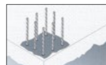
新增混凝土柱
